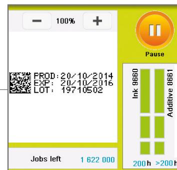
Система обеспечивает **высокий уровень бесперебойной работы**, благодаря точному отображению на дисплее расхода материалов и простой операции по их замене, не требующей остановки производства.
